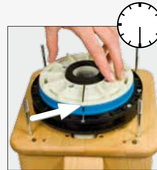
Photo 7 Les marques noires doivent être l'une en face de l'autre.
